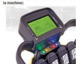
MTRS (Permet de coupler plusieurs émetteurs à un récepteur ou inversement)
