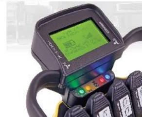
MTRS (Permet de coupler plusieurs émetteurs à un récepteur ou inversement)
